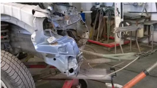
Se trata de un método de reparación de elementos estructurales de los vehículos. Para ello, utilizando los útiles de medida adecuados, se comprueban las deformaciones que ha sufrido la estructura y así se pueden deducir los estirajes que hay que realizar para restituir la misma a sus cotas originales. Para el estiraje se emplean gatos hidráulicos de gran calibre, que pueden aplicar esfuerzos de varias toneladas. Al conjunto de útiles de medida y de tiro se le denomina bancada.
