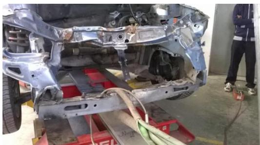
En las fotos se puede ver un tiro de una traviesa frontal mediante el gato hidráulico y eslinga.
